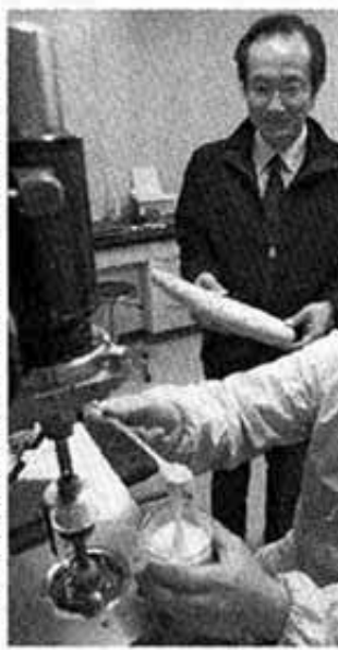
すり下ろしたナガイモの粘りけを測定する装置。後方がフリーダーの小嶋(あせ) 浩・帯広大助教授
